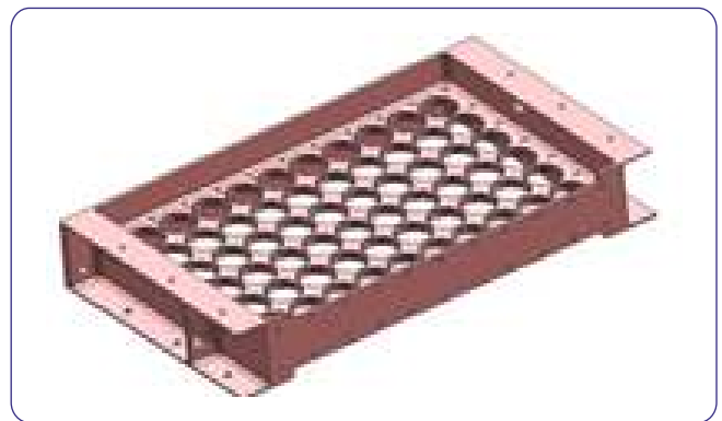
थर्मो बनाने वाली पंच और डाई का निर्माण उत्पाद सीएनसी मीलिंग मशीन पर एल्युमीनियम सामग्री में निर्मित होता है।
