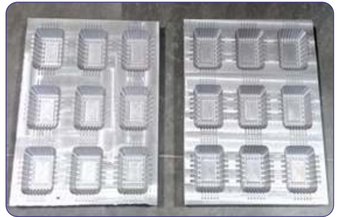
थर्मो बनाने वाली पंच और डाई का निर्माण उत्पाद सीएनसी मीलिंग मशीन पर एल्युमीनियम सामग्री में निर्मित होता है।
